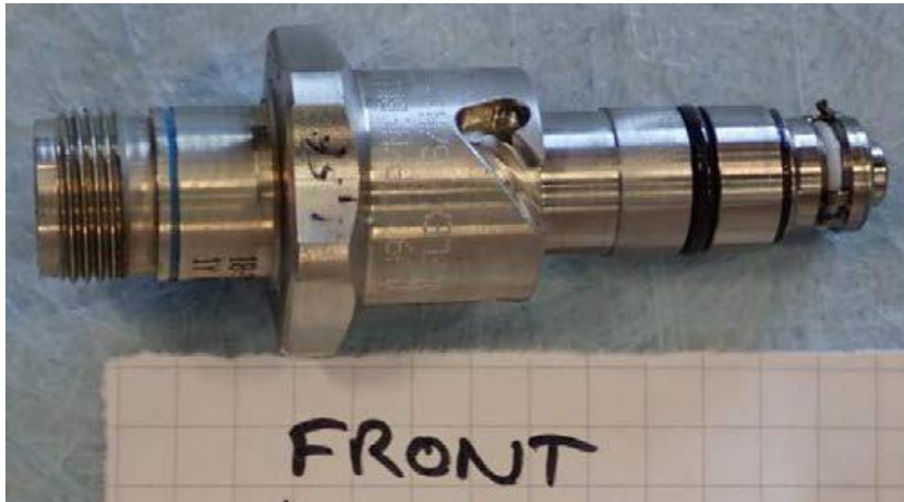
სურათი 7: მოდულ 01-ის ელექტრო-მაგნიტური სარქველი მეტალის ნაწილაკებითურთ.
