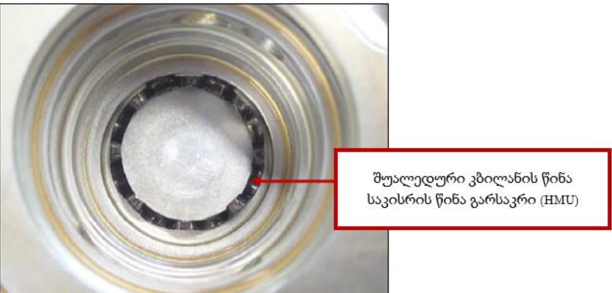
სურათი 28: ორი გარსაკრიდან ერთერთი ნაპოვნი იქნა შუალედური კბილანის წინა საკისრის ბუდეში. გარსაკრის დამჭერების დაკარგვის გათვალისწინებით ეს იყო მოსალოდნელი შედეგი კბილანის მოხსნის შემდეგ.
