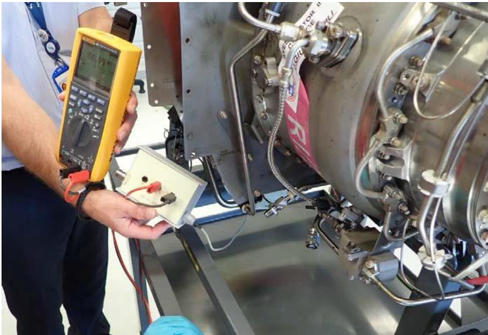
სურათი 6: მოდულ 02-ის ელექტრო-მაგნიტური სარქველის სადენების ელექტრული წრედის უწყვეტობაზე ტესტირება
