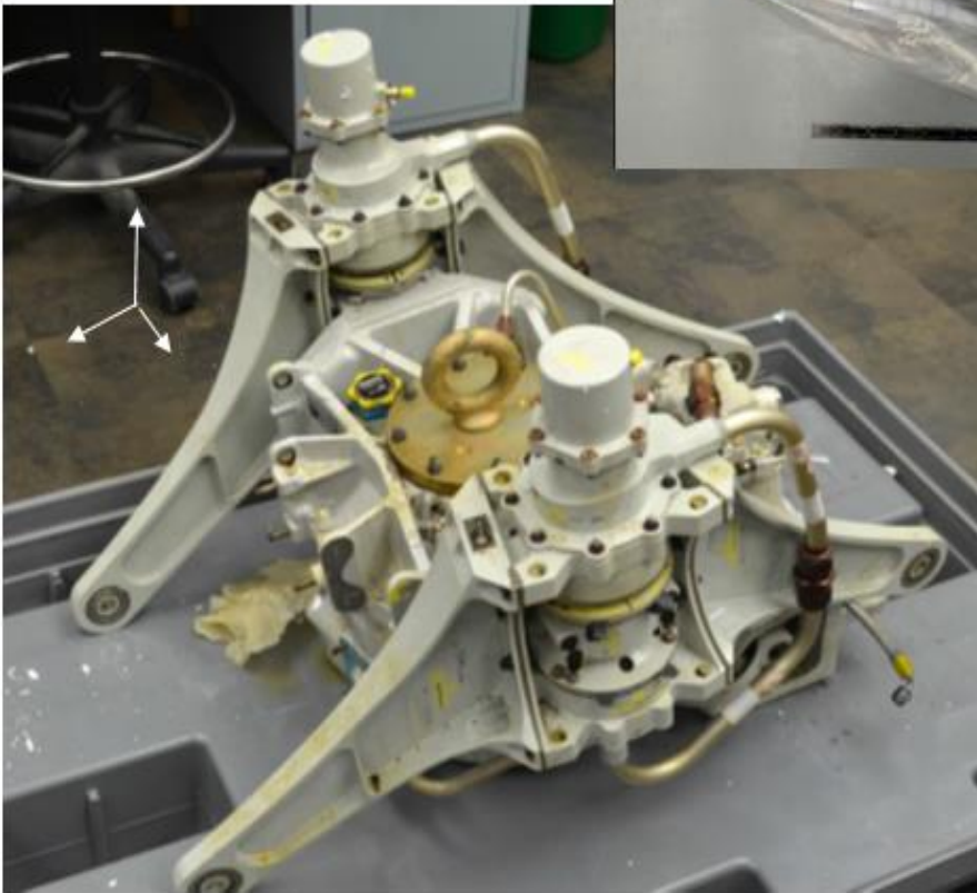
სურათი 1. ექსპერტიზისთვის მიღებული კონტეინერის და მასში მოთავსებული დეტალების(მთავარი რედუქტორი და მასზე დამონტაჟებული ანტივიბრაციული დემპფერი, ძრავის სიმძლავრის მართვის ბერკეტი) საერთო ხედი.
