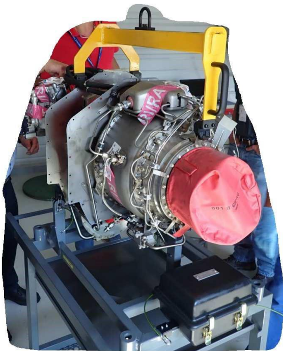
სურათი 4: ძრავა დამონტაჟდა სამუშაო სტენდზე
