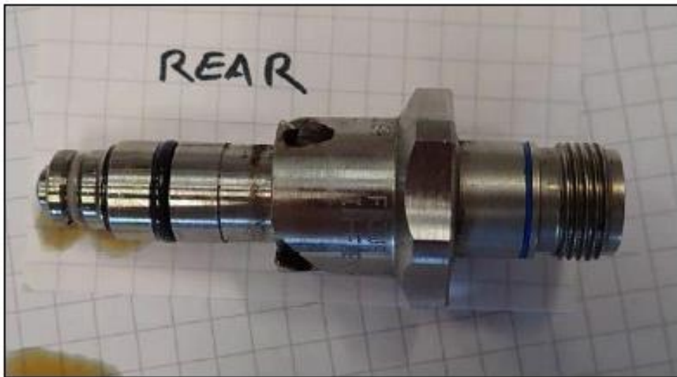
სურათი 9: მოდული 02-ის ელექტრო-მაგნიტური სარქველი სუფთაა.
