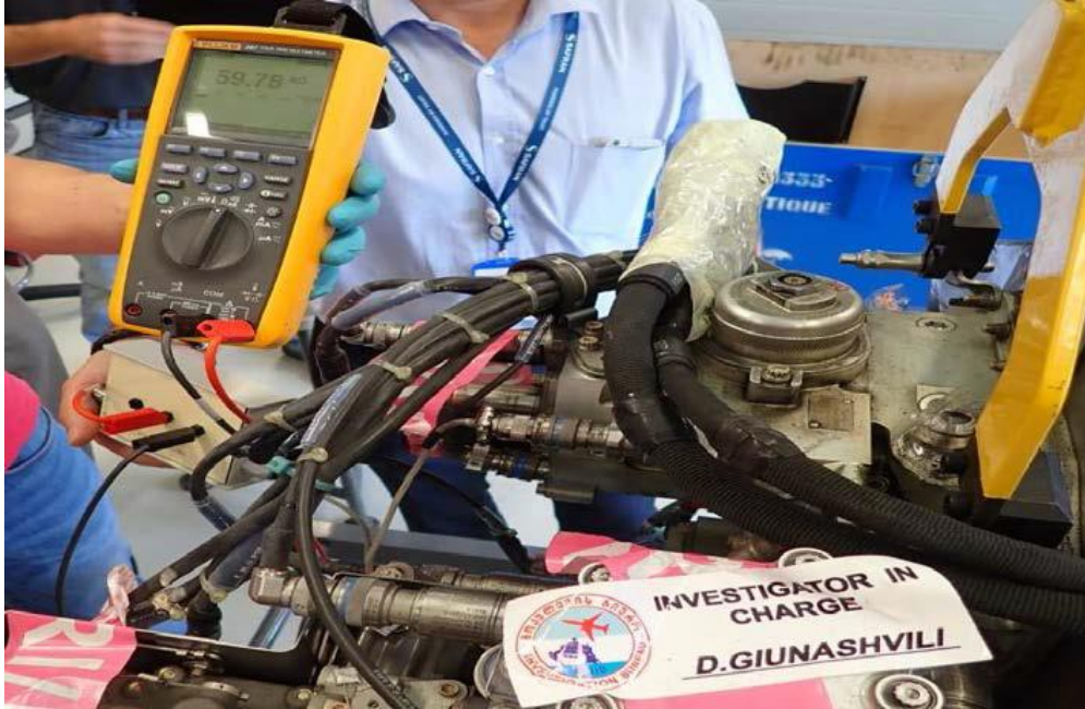
სურათი 5: მოდულ 01-ის ელექტრო-მაგნიტური სარქველის ავიონიკასთან დამაკავშირებელი სადენების ელექტრული წრედის უწყვეტობაზე ტესტირება
