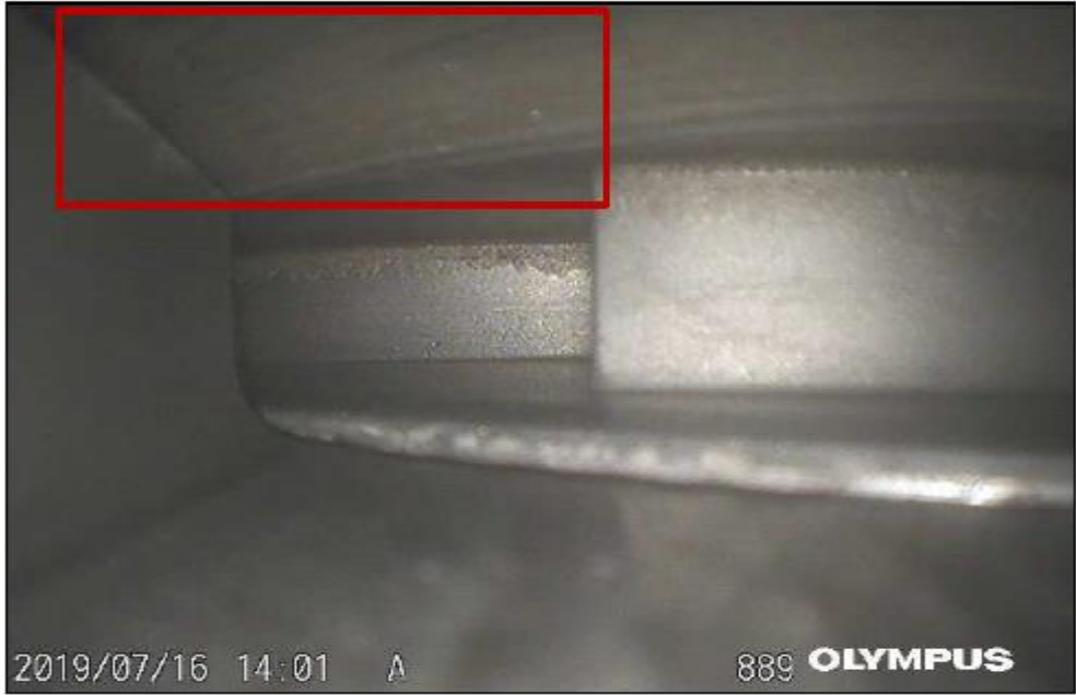
სურათი 13: კვალი კომპრესორის ხუფზე, მბრუნავი მუშა თვლის უკანა პირის სექტორში (წითელი მართკუთხედი)
