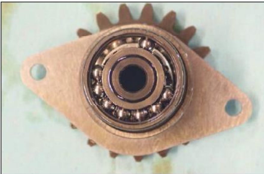
სურათი 30: „HMU“-ს შუალედური კბილანის წინა საკისარი: ბურთულები არ იყო დაკარგული.
