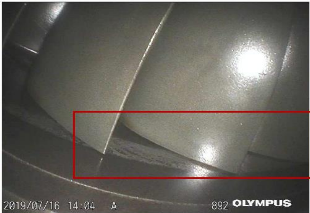
სურათი 14: დაზიანების კვალი თავისუფალი ტურბინის გარსაცმზე (წითელი მართკუთხედი)
