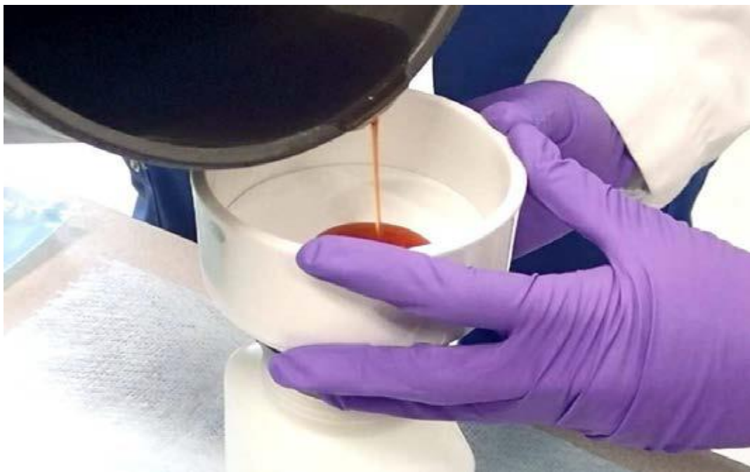
სურათი 17: გადაცემათა კოლოფიდან ამოღებული ძეთის გაფილტვრა.
