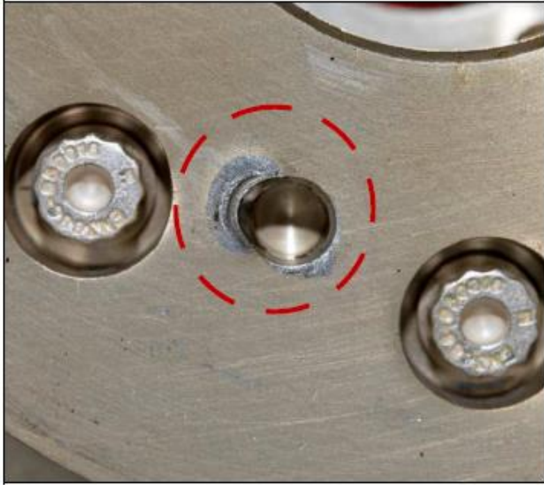
სურათი 19: პოზიციონირების ღეროს სექტორში დაზიანების (ოვალიზაცია) ტიპი.
