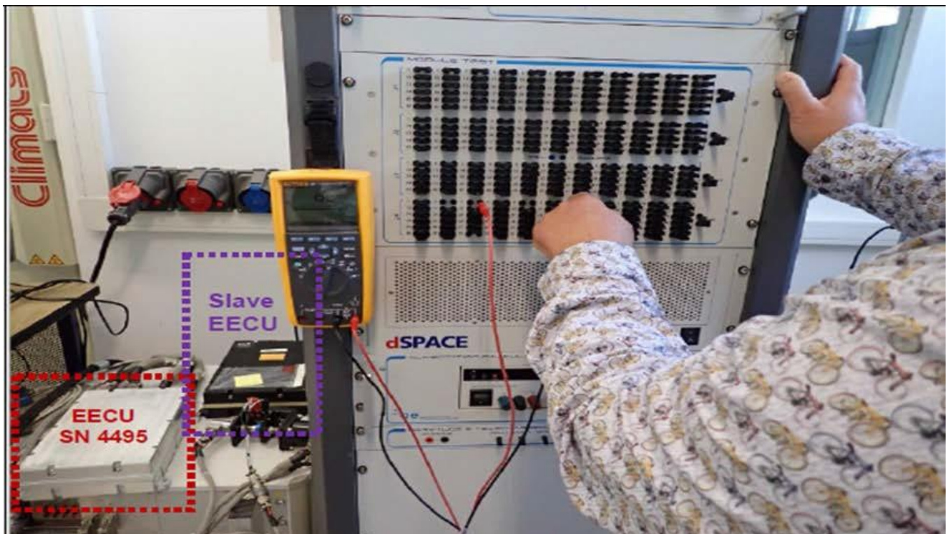
სურათი 4: EECU SN4495 დაკავშირებულია ელექტრონულ სატესტო მოწყობილობასთან და მოწმდება წრედის უწყვეტობაზე.
