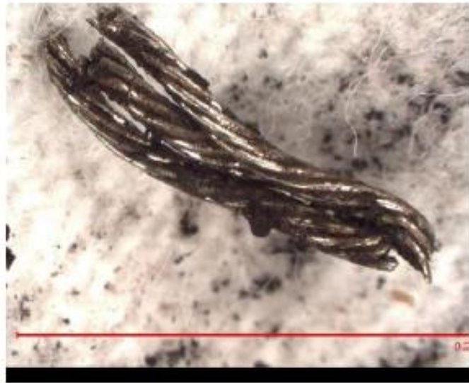
სურათი 5: უსაფრთხოების მავთულის წარჩენი ნაპოვნნი იქნა ჭანჭიკზე დატანილ ფოსოში.
