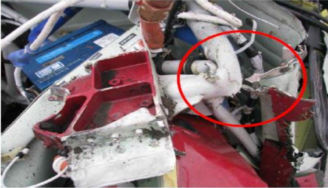
სურათი 3 მიწასთან ძლიერი შეჯახებით გამოწვეული დაზიანება ფერმის ქვედა ჩამაგრების ადგილას
